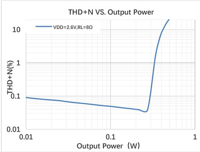
图 4. 功率失真曲线  $V_{DD}=2.6V$   $R_L=8\Omega$
