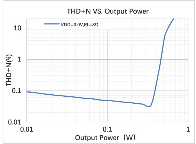
图 5. 功率失真曲线  $V_{DD}=3.0V$   $R_L=8\Omega$
