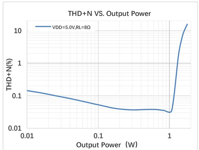
图 9. 功率失真曲线  $V_{DD}=5V$   $R_L=8\Omega$
