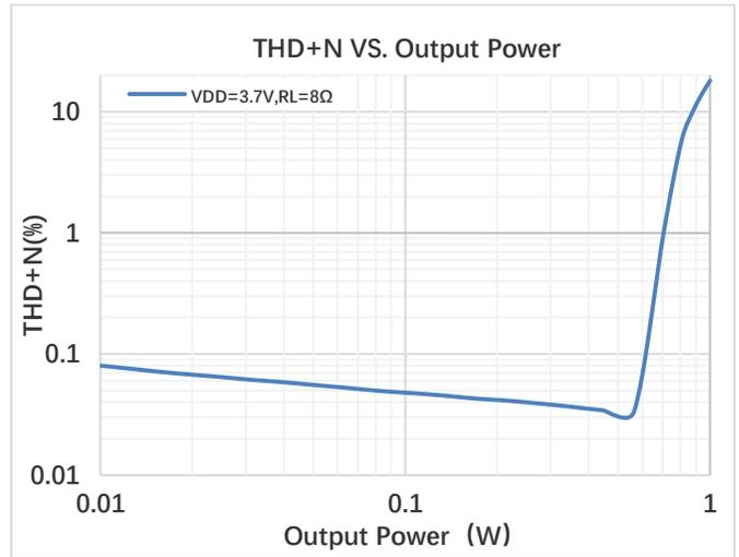
图 7. 功率失真曲线  $V_{DD}=3.7V$   $R_L=8\Omega$
