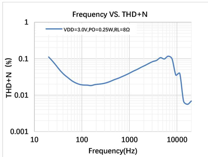
图 11. 频率失真曲线  $V_{DD} = 3.0V$   $R_L = 8\Omega$
