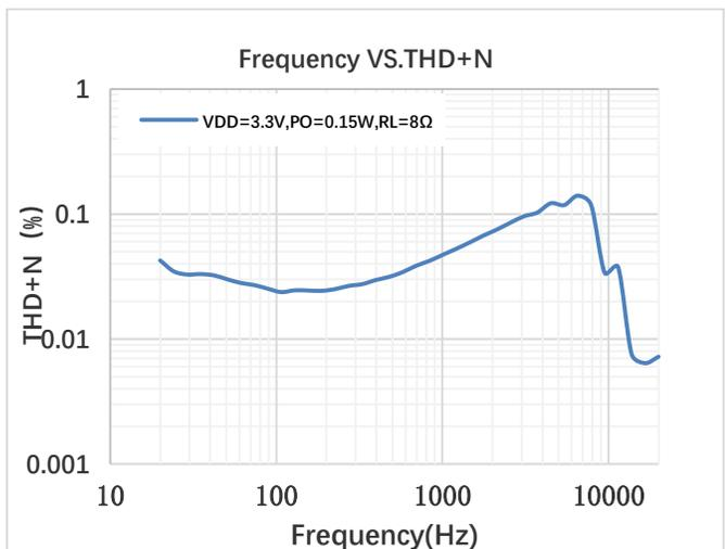
图 12. 频率失真曲线  $V_{DD} = 3.3V$   $R_L = 8\Omega$
