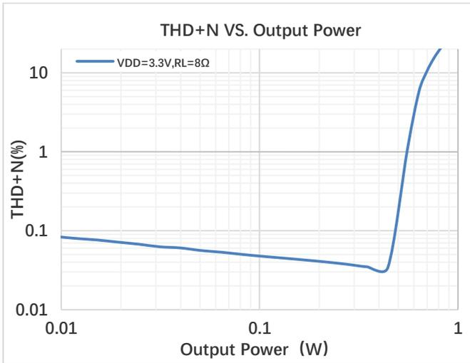
图 6. 功率失真曲线  $V_{DD}=3.3V$   $R_L=8\Omega$
