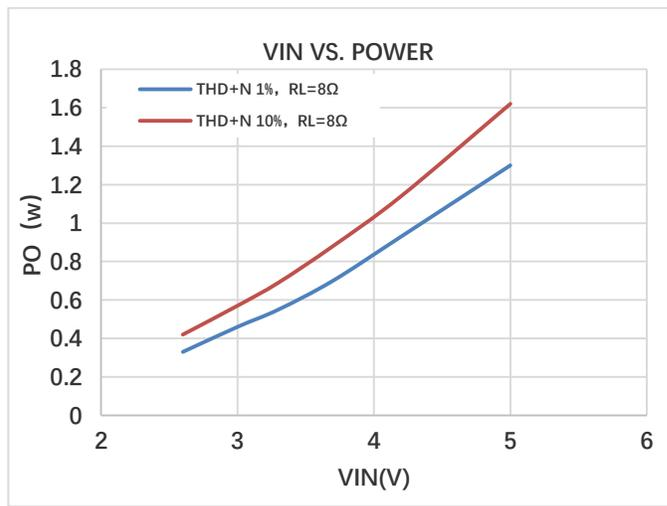
图 15. 输入电压 & 输出功率
