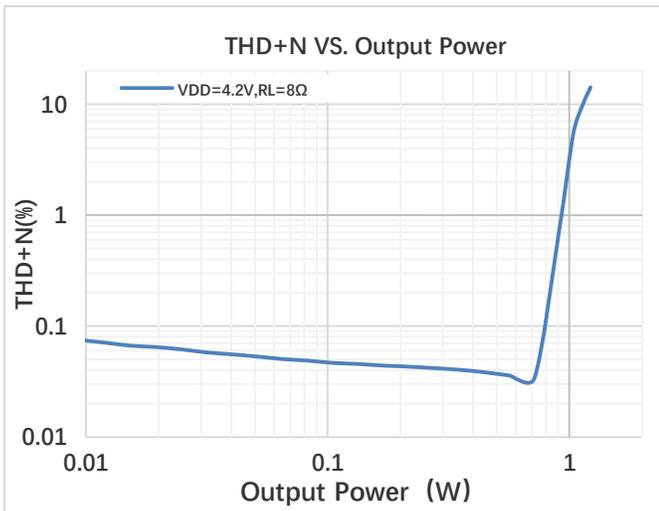
图 8. 功率失真曲线  $V_{DD}=4.2V$   $R_L=8\Omega$
