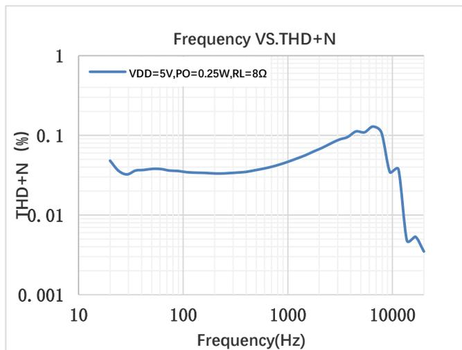
图 13. 频率失真曲线  $V_{DD} = 5V$   $R_L = 8\Omega$
