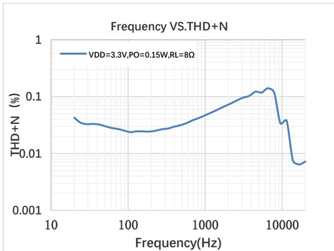
图10. 频率失真曲线  $V_{DD} = 2.6V$   $R_L = 8\Omega$
