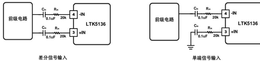
LTK5136增益由外部电阻来配置, 输入电阻器  $R_{IN}$  可以来设置调节增益大小,  $R_F$  由芯片内部已集成, LTK5136内部集成的  $R_F$  为  $300k\Omega$ ,  $R_{IN}$  由外部调节定义其增益大小, 其计算公式如下:
